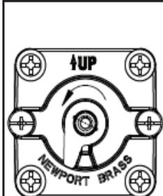
LIMIT STOP HITS STOP BLOCK AT HIGHEST DESIRED TEMPERATURE
