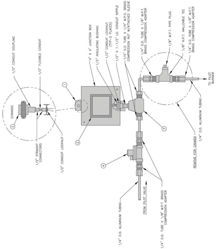
**TRANSFORMER, PENN #H91WA-4 PILOT SOLENOID VALVE & PILOT LINE REGULATOR
