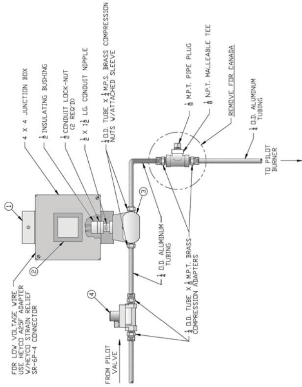
TRANSFORMER, PENN #H91WG PILOT SOLENOID VALVE & PILOT LINE REGULATOR
