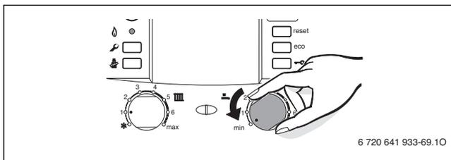
Fig. 69 Frost protection for the DHW tank
