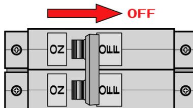
**À utiliser uniquement sur un circuit de dérivation individuel.** Le chauffe-eau doit être installé en utilisant uniquement un circuit de dérivation individuel, en utilisant un câble isolé, homologué UL, à 2 fils (2 fils plus mise à la terre) de la taille appropriée convenant jusqu'à 75 °C et protégé par un disjoncteur de capacité nominale adéquate.
