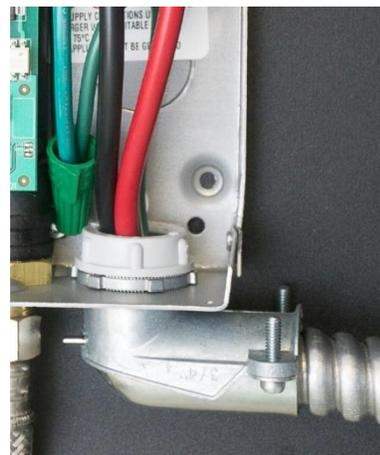
Les câbles d'alimentation doivent être fixés aux connecteurs L1 et L2 ou L et N sur le bornier ou le relais. Le fil de terre doit être fixé au connecteur de mise à la terre (GND) du bloc ou au fil de terre vert à l'aide de l'écrou fourni.
