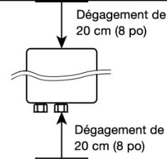
Retirez le couvercle et fixez au mur à l'aide des trous de fixation situés à chaque coin de la plaque arrière. Remettez le couvercle en place.
